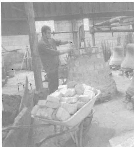
Macho en fase de construcción avanzada. (Fot. R. Ruiz - D.M.)
