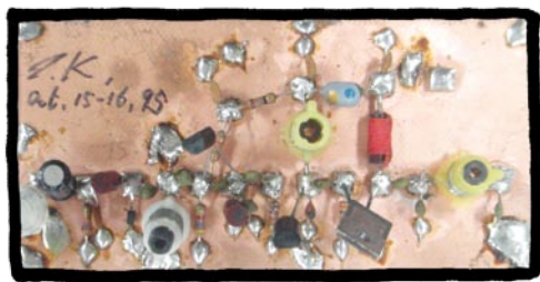
Radio assemblée et soudée sur cuivre par Tetsuo Kogawa.
